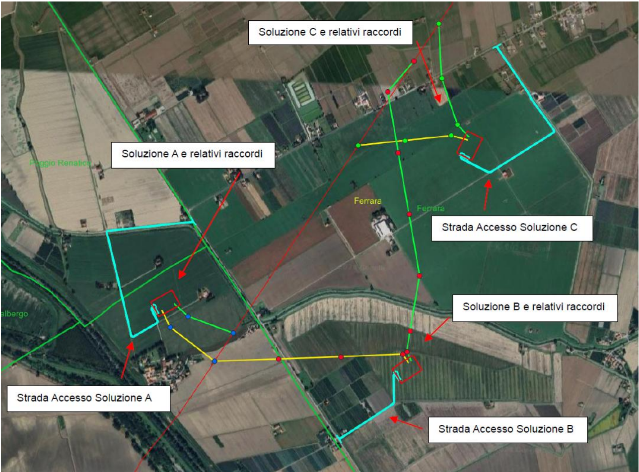
Figura 32: soluzioni progettuali e dei relativi raccordi per la SE 132 kV "Molinella"
